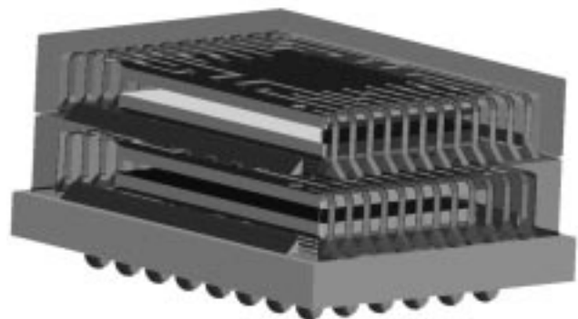
Afbeelding 4. De door TNO ontwikkelde 3D-MEMS Scale Package (3DMSP)
