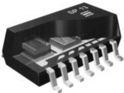
Afbeelding 1. Een voorbeeld van een hybride microsysteem, een druksensor
