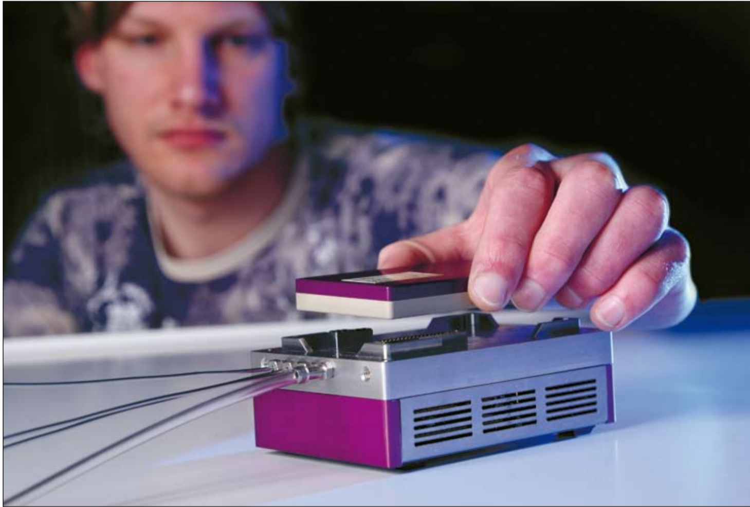
De chip zit in een cartridge met daarin onder meer de elektronica voor temperatuurbeheersing
